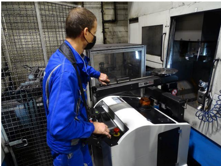
Bildunterschrift 3: Roland Taba, Einrichter bei Buderus, führt die neue mobile Technik zum Spannfutterwechsel vor.
